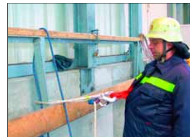
Rückhalten mit dem AFG 300 in Verbindung mit einem an scharfen Kanten geprüften Seil
